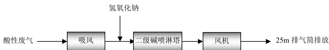
图 8.1-3 酸性气体处理工艺流程示意图
