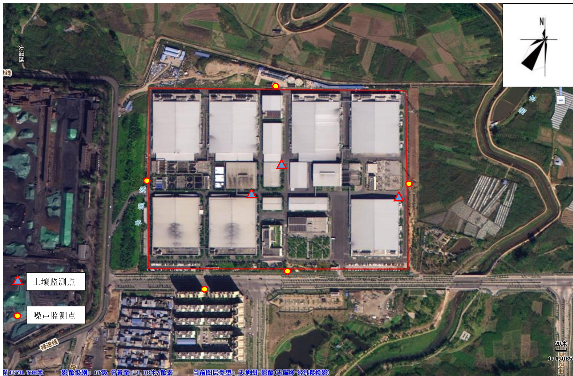
附图 12 本次技改项目噪声和土壤环境现状监测布点示意图
