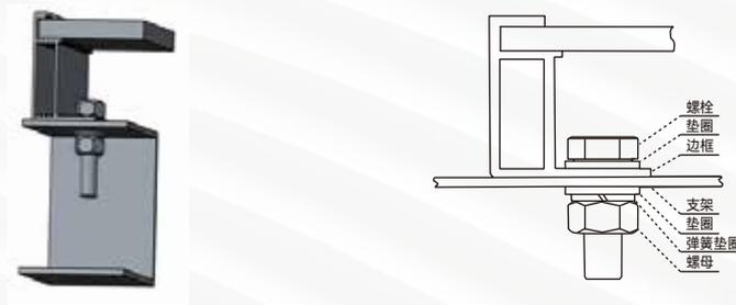
图 5 组件安装孔安装图示
